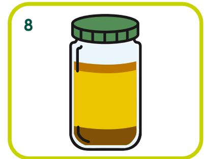
8. Si le liquide n'est pas homogène, essayez d'apporter une portion de chacun des composants (solides ou liquides), pour que l'échantillon puisse collecter la totalité des éléments.
